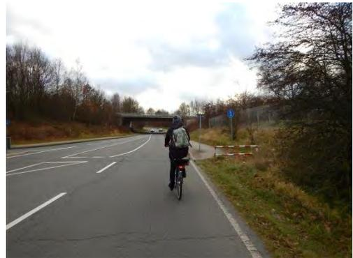
Bild 68: Fehlende Radverkehrsanlage und ungesicherte Querung Lilienthalstraße
