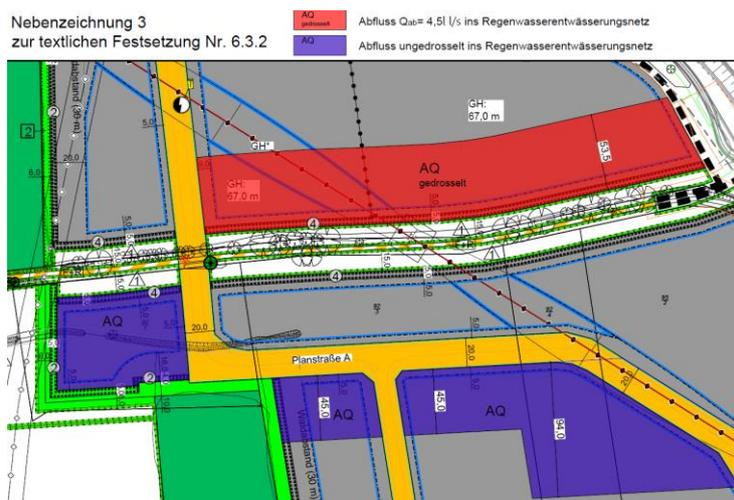
Abbildung 14: Nebenzeichnung 3 zur Oberflächenentwässerung –AQ gedrosselt: Gedrosselte Einleitung in das Regenwasserentwässerungsnetz ; AQ: Ungedrosselte Einleitung in das Regenwasserentwässerungsnetz (RWEN).
