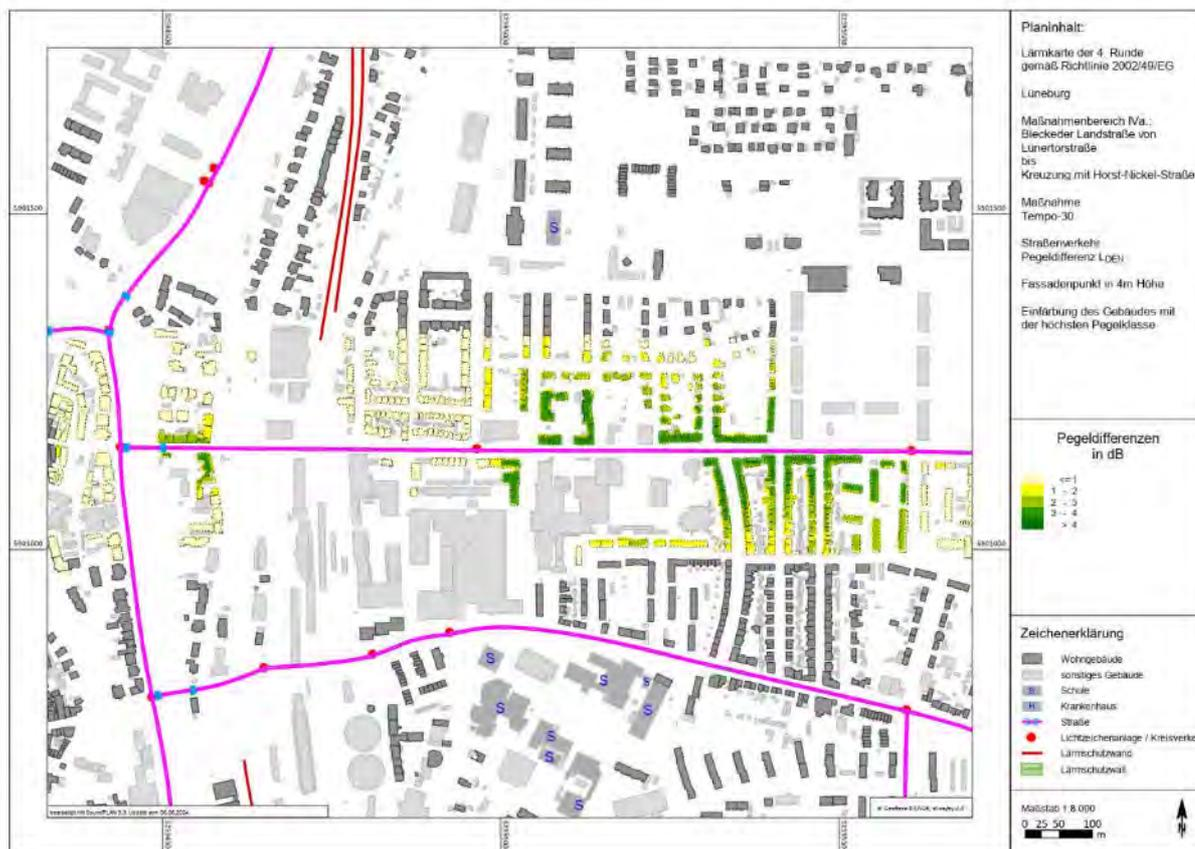
Abbildung 20: Differenzlärnkarte zur Maßnahme Temporeduzierung im Maßnahmenbereich IV<sub>a</sub>
