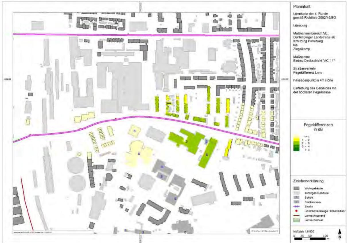
**Abbildung 26:** Differenzlärmkarte zur Maßnahme Deckensanierung im Maßnahmenbereich V<sub>b</sub>
