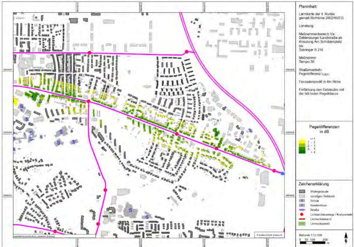
**Abbildung 24:** Differenzlärmkarte zur Maßnahme Temporeduzierung im Maßnahmenbereich V<sub>a</sub>
