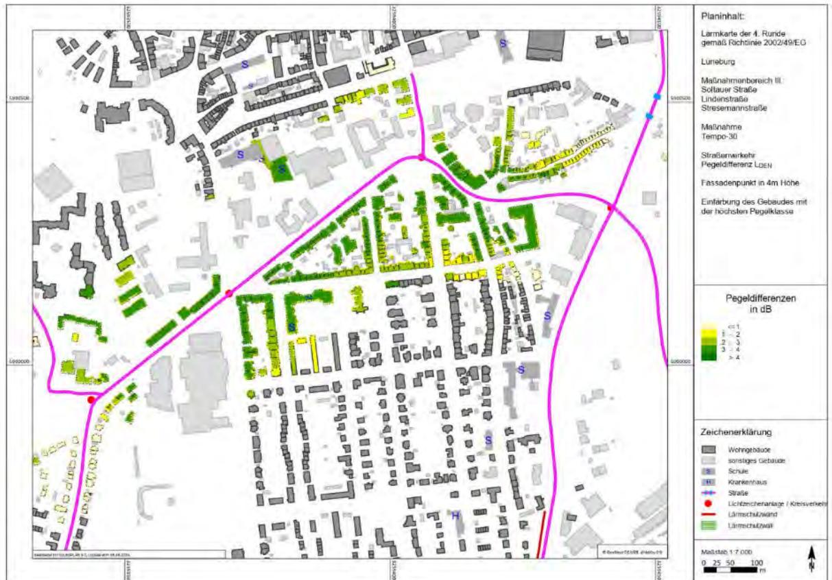
Abbildung 18: Differenzlärmkarte zur Maßnahme Temporeduzierung im Maßnahmenbereich III
